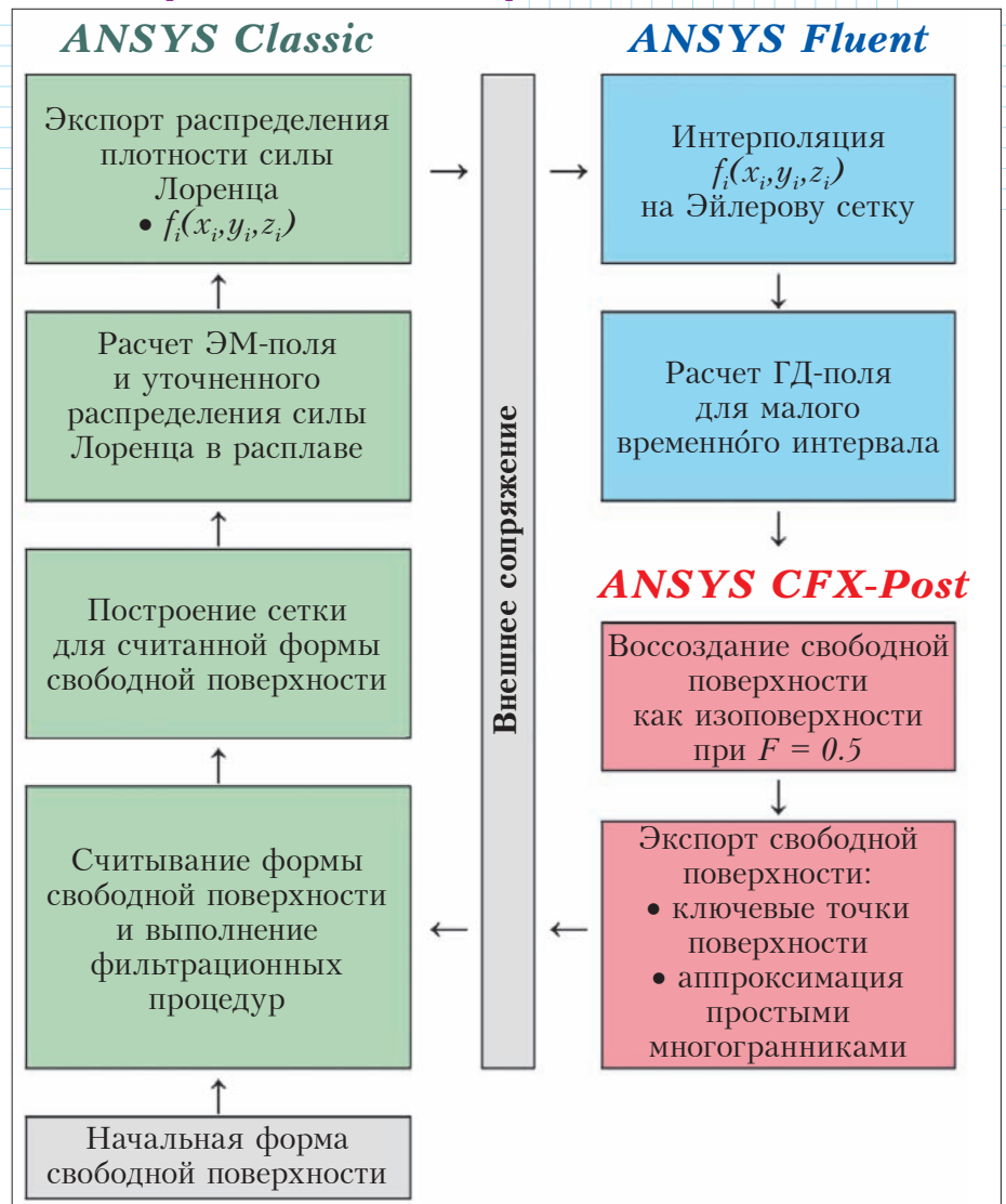
Табл. 1. Численное моделирование динамики свободной поверхности расплавленного металла: сопряжение расчетных задач для определения ЭМ- и ГД-полей
