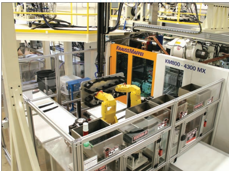
Рис. 4. Гибкая производственная ячейка использует пресс-форму с возможностью впрыска двух разных материалов для изготовления двух наборов внутренних дверных панелей. Извлекает детали из пресс-формы промышленный робот со специально оснащенный рабочим органом. На завершающем этапе сборки два 5-осевых манипулятора вставляют предварительно отлитые пластмассовые заклепки (фотография любезно предоставлена компанией MGS Manufacturing)
