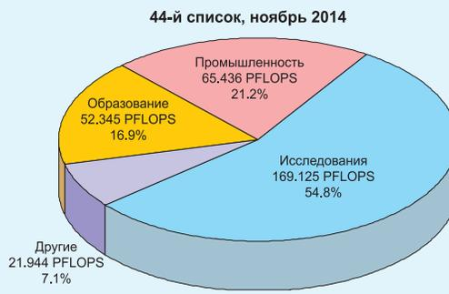
*Рис. 4. Распределение суммарной производительности систем из Top500 по областям применения в 2014 г. (список 44)*
