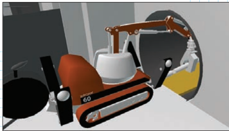
Рис. 6. Положение манипулятора МРУ с насадкой-захватом и зажатым в ней обрезком для прохождения через трубу
