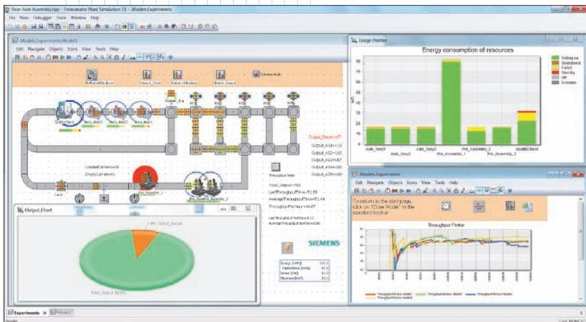
Модуль Plant Simulation рассчитывает энергопотребление как отдельных станков, так и целых производственных линий, а также позволяет моделировать различные стратегии энергосбережения
