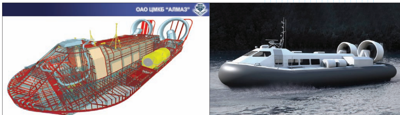
Рис. 1. Пример разработки в единой среде проектирования судов с динамическим принципом поддержания
