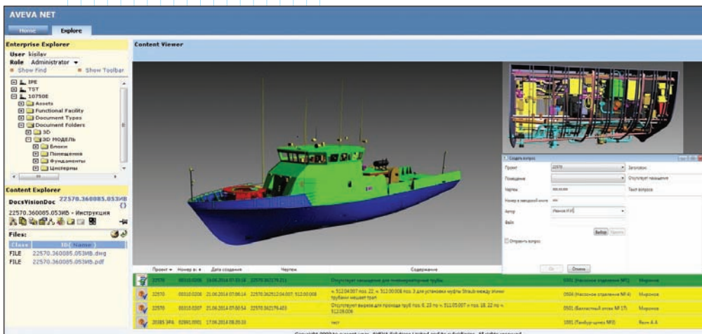
Рис. 3. Единая среда проектного и завода-строителя для обеспечения технического сопровождения и подготовки производства
