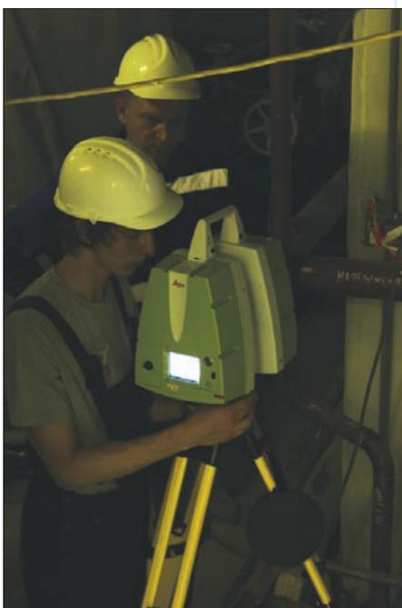
Рис. 6. Установка 3D-лазерного сканера на штатив
