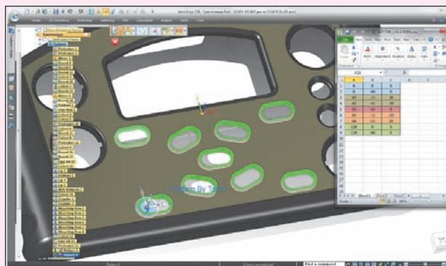
*Параметры массивов элементов модели можно загружать из таблицы формата XLS, что упрощает создание массивов неправильной формы*
