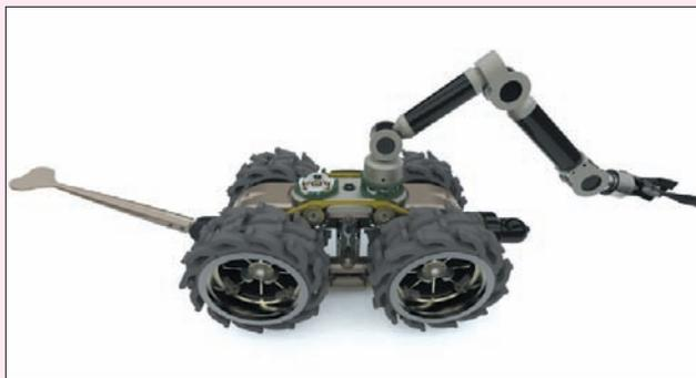
Модульного робота “Armourdillo” (броненосец) компания *Robosynthesis Ltd.* полностью спроектировала в системе *Solid Edge*
