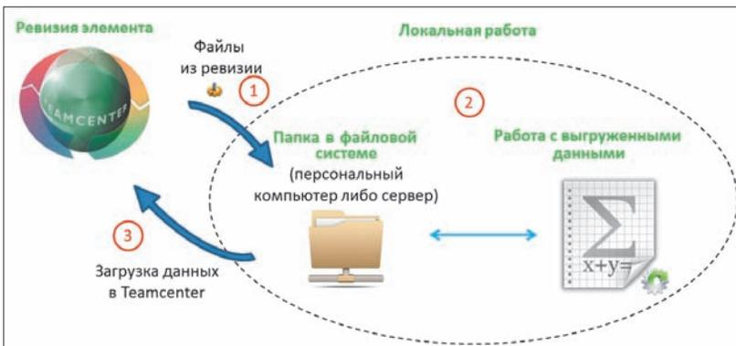
Рис. 8. Принцип работы “Инструмента симуляции”
