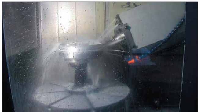
Обработка детали на 5-координатном станке с ЧПУ с кинематикой X-Y-Z-A-B
