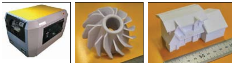
Рис. 14. Mcor Matrix 3D Paper Printer и примеры моделей
