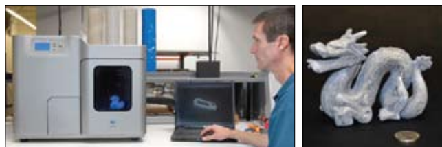
Рис. 12. Desktop Factory 125ci 3D Printer и пример модели
