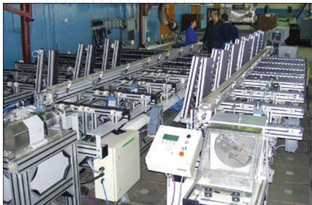
Эта линия подготовки оболочек спроектирована с использованием Autodesk Inventor
