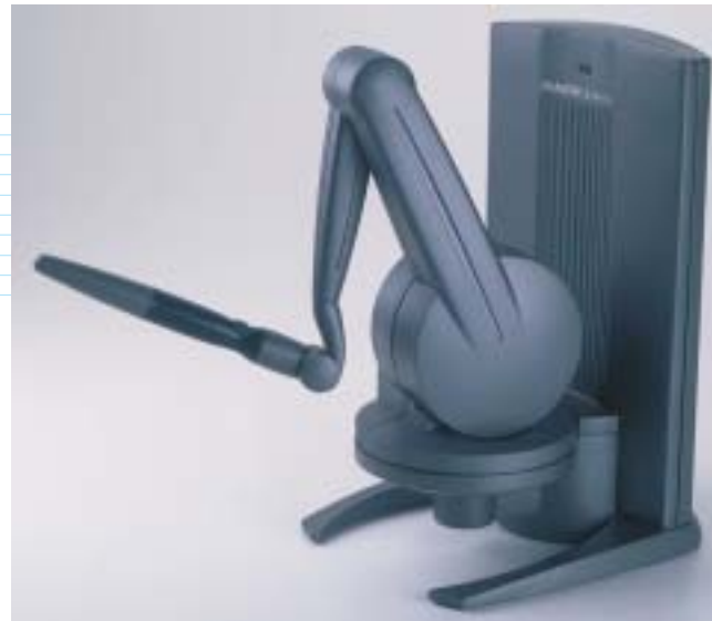
Phantom Desktop – устройство ввода, входящее в комплект Freeform Modeling Plus
