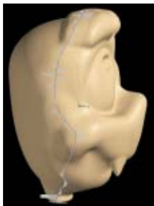
Индикаторы кривизны, наложенные на линию разреза модели, помогают определить места, где лучше сгладить эту кривую
