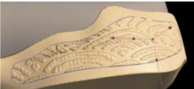
Текстура на подошве обуви (система масштабирует рисунок в соответствии с размером детали)
