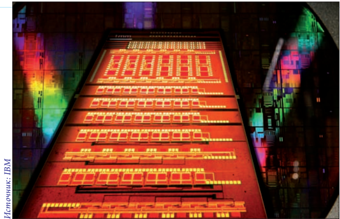
Рис. 1. Микросхема, выполненная по технологии CMOS Integrated Silicon Nanophotonics (горизонтальный размер микросхемы составляет примерно 5 мм) Chip based on CMOS Integrated Silicon Nanophotonics technology (chip horizontal size is approximately 5 mm)
