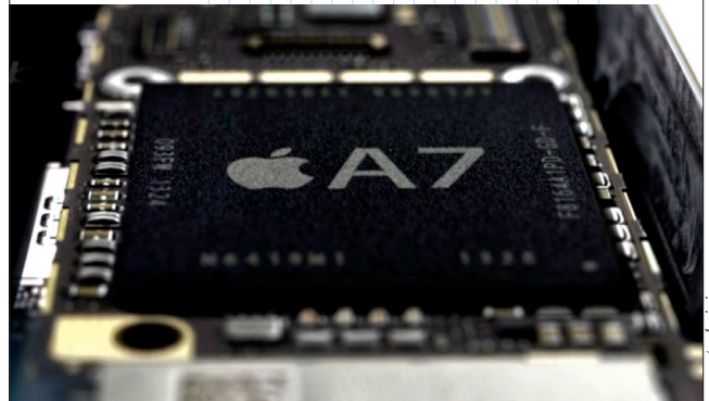
Рис. 20. Процессор Apple A7 – первый 64-битный процессор для смартфона, а также первый на базе архитектуры ARM 64-bit
