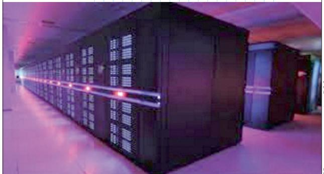
Рис. 1. Tianhe-2 или Milky Way-2 (Китай) с реальным быстродействием 33.8627 PFLOPS, лидер суперкомпьютерного рейтинга *Top500* в июне 2013 года, смонтирован из 32000 процессоров *Intel Xeon E5-2692* (12 ядер, 2.2GHz) и 48000 сопроцессоров *Intel Xeon Phi* (57 ядер, 1.1 GHz)
