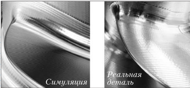
При прогнозировании качества поверхности система визуализации учитывает геометрию, скорости подачи и резания
