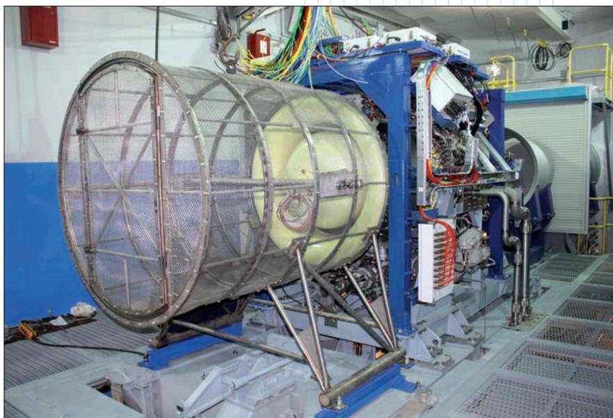
Рис. 2. Газогенератор-демонстратор ПД-14 на испытательном стенде
