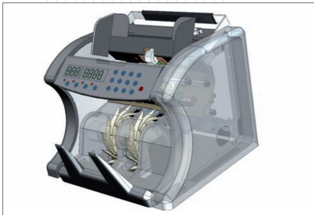
Детализированная 3D-модель купюросчеточной машины ScanCoin 803. С.С. Усков, Харьковский национальный университет радиоэлектроники
