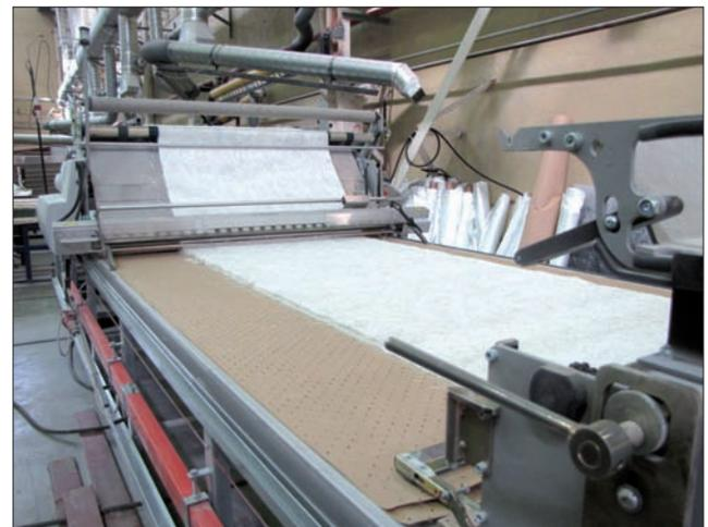
*Установка автоматизированного раскроя армирующей стеклоткани*
