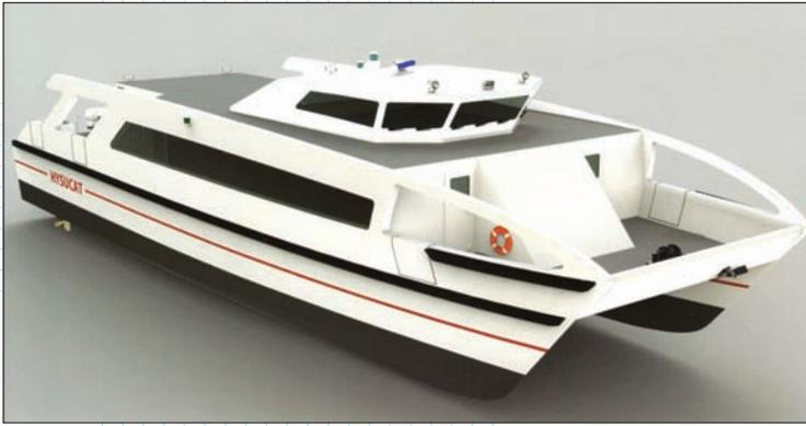
*Проект 150-местного пассажирского катамарана с корпусом из композиционного материала*
