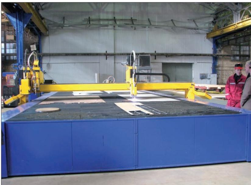
*Установка плазменной резки*
