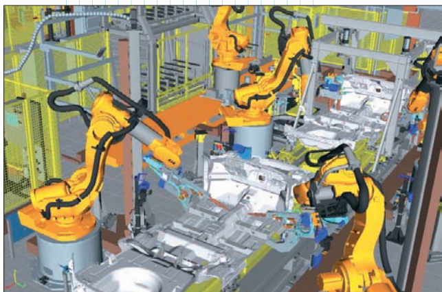
Сборочная линия автомобилей VOLVO V70 и V60 на заводе VOLVO Car Corp. в г. Торсланда (Швеция): виртуальная симуляция и сборочный процесс в цехе
