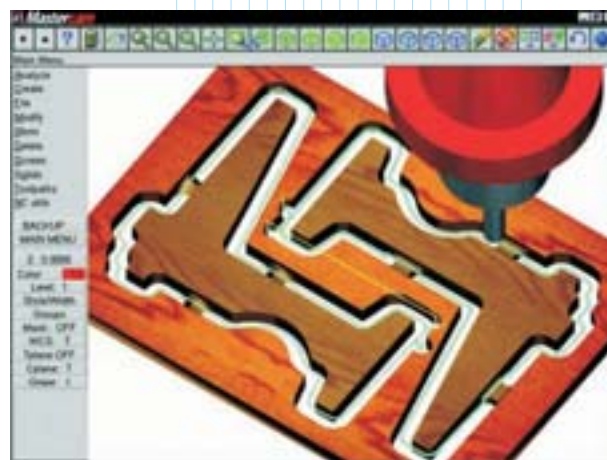
Для вырезания фрезой деталей из древесной плиты Mastercam оставляет фиксирующие перемычки
