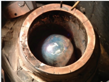
Рис. 2. ИПХТ для получения сплава TiAl [8]
