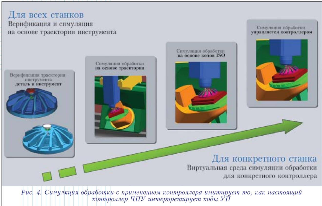
Рис. 4. Симуляция обработки с применением контроллера имитирует то, как настоящий контроллер ЧПУ интерпретирует коды УП
