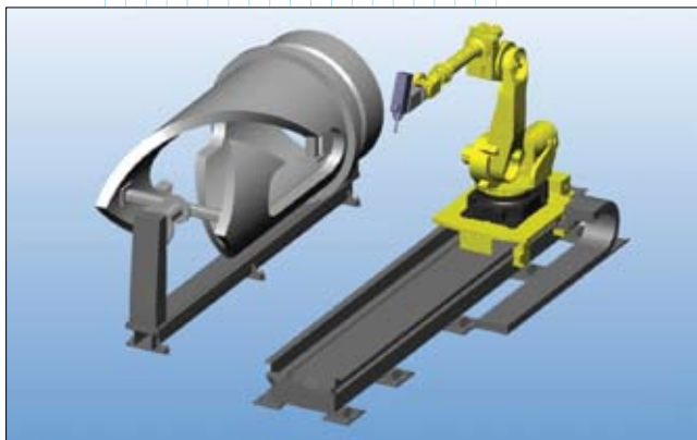
Робот размещен на линейной направляющей, а деталь – на поворотной оси
