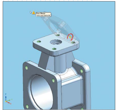
Рис. 8. Если Direct Edit не может произвести желаемого пользователем изменения, то уже в процессе динамического предпросмотра выводится предупреждение и результат внесенного изменения исчезает. Прекрасная обратная связь!
