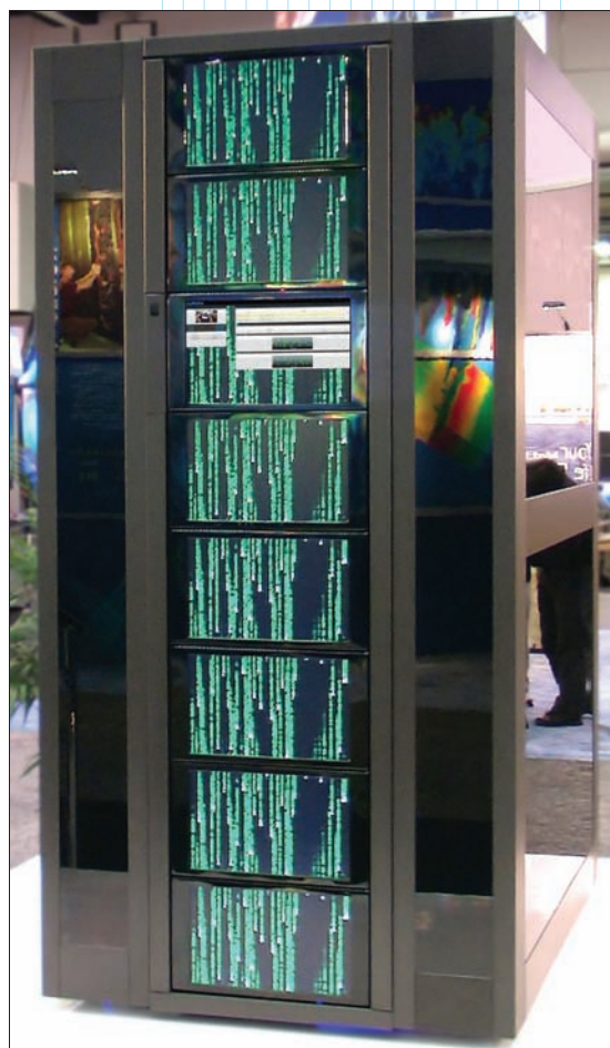
Рис. 1. Шкаф вычислителя “СКИФ Аврора”
