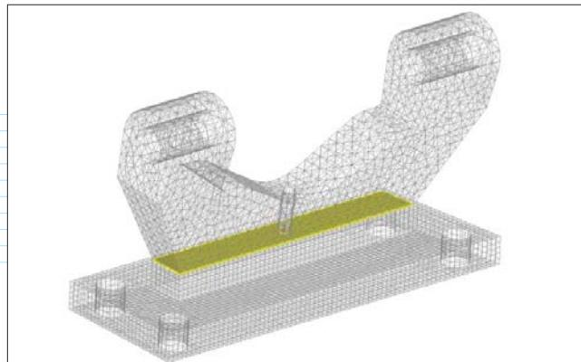
Рис. 2. В новой версии *Femap* требования к сеткам контактирующих деталей стали значительно менее жесткими, что существенно упрощает моделирование сложных структур
