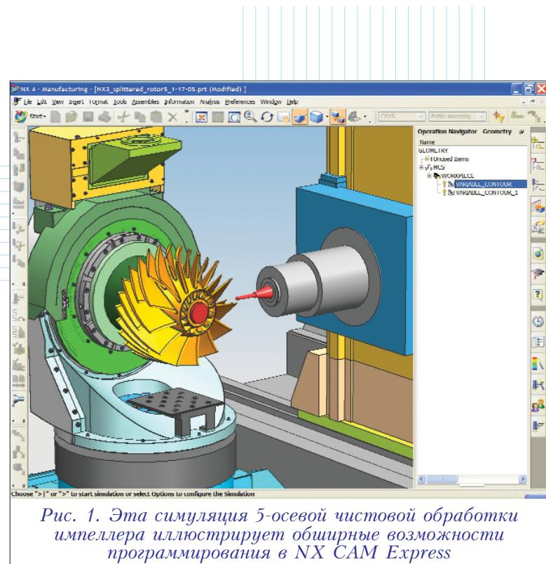
**Рис. 1.** Эта симуляция 5-осевой чистовой обработки импеллера иллюстрирует обширные возможности программирования в *NX CAM Express*
