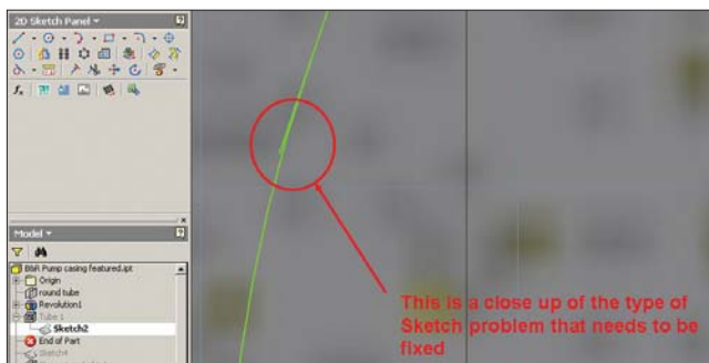
Рис. 3. По словам представителя службы технической поддержки Autodesk, из-за таких необрезанных элементов эскиза Inventor 11 впоследствии не позволяет делать скругления
