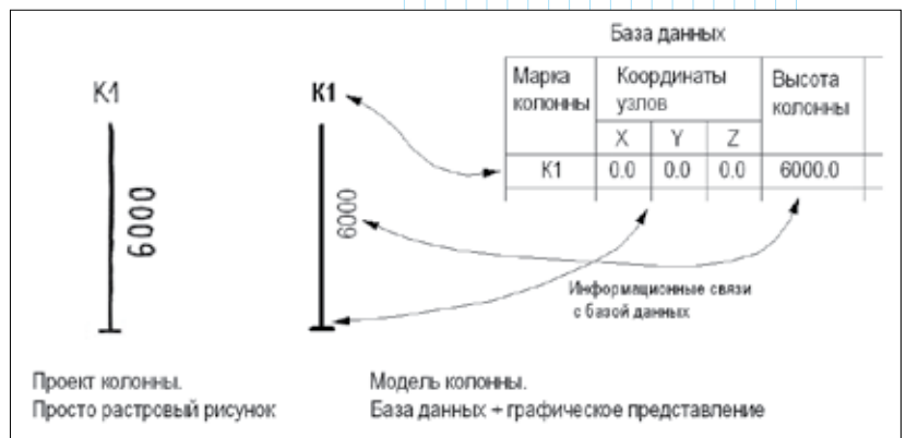
Рис. 1. Проект и модель колонны
