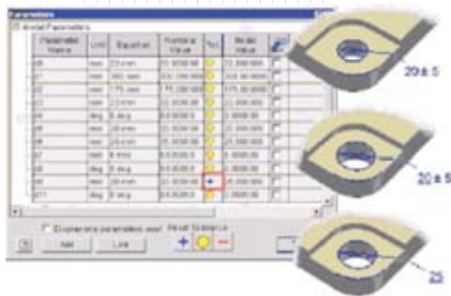
Рис. 9. Работа с максимальными предельными отклонениями размеров конструктивных элементов
