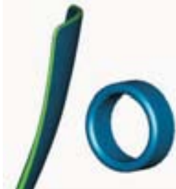
Рис. 3. Full round fillet удобна для скругления – необходимо лишь выбрать две грани, на которых нужно построить скругления, и поверхность, которая будет охвачена этим скруглением
