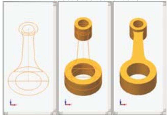
Рис. 2. Комплексный подход к моделированию и поддержка нескольких тел в одном файле делают работу более гибкой (в левом окне – эскиз, определяющий концепцию; в центре – создание цилиндрических КЭ на основе двух непересекающихся контуров; в правом – законченная деталь. Толщина средней части и цилиндрических элементов различная)
