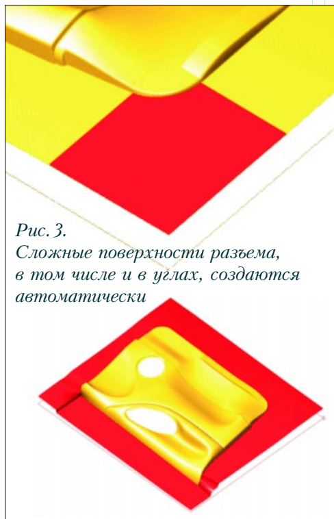
Рис. 2. Разноцветная закрашка модели позволяет выявить области, где уклоны отличаются от допустимого
