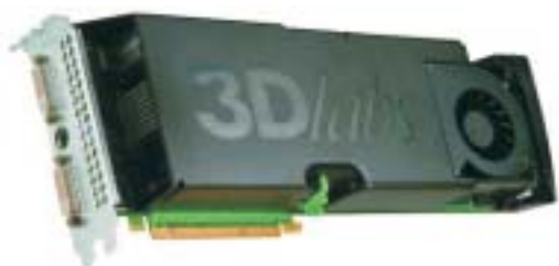
Новая карта 3Dlabs Realizm 800 стандарта PCI Express относится к классу Ultra High-End . Два VPU нового поколения неплохо сочетаются с новым вертексным модулем обработки Vertex/Scalability Unit (VSU) и 640 Mb графической памяти
