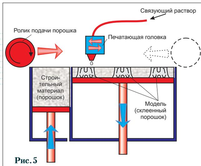
по поверхности порошкового слоя – точно так же, как струйные принтеры и плоттеры распределяют чернила по поверхности бумаги. Связующий раствор пропитывает порошок, прочно склеивая его частицы. После того как завершается «печать» первого слоя, строительная платформа опускается. Поверх первого слоя распределяется новая порция исходного материала. Этот процесс продолжается до полного завершения построения модели.
