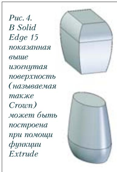
Рис. 4. В *Solid Edge 15* показанная выше изогнутая поверхность (называемая также *Crown*) может быть построена при помощи функции *Extrude*
