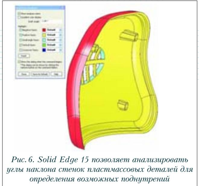
Рис. 6. *Solid Edge 15* позволяет анализировать углы наклона стенок пластмассовых деталей для определения возможных поднутрений
